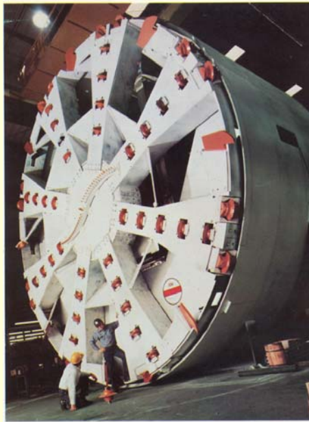
Vista frontal de la rueda excavadora del escudo
